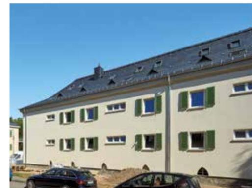
Nachher: gedämmte Fassade, isolierverglaste Fenster
